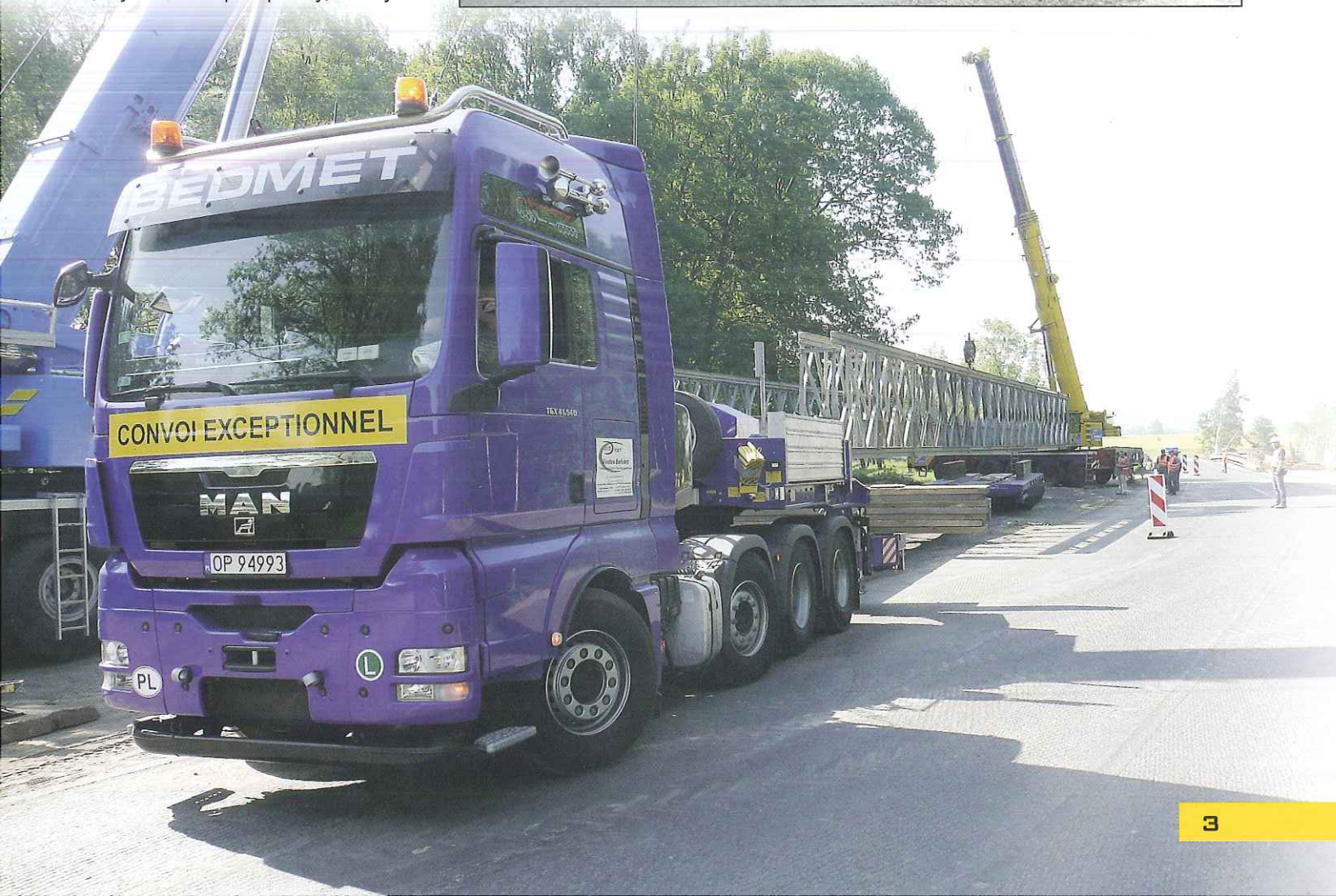
Skrętne osie naczepy pomagają przy pokonywaniu łuków. Wówczas skręcają w przeciwną stronę niż koła ciągnika. Hydrauliczne zawieszenie umożliwia dostosowanie się do ładunku lub do warunków drogowych.
